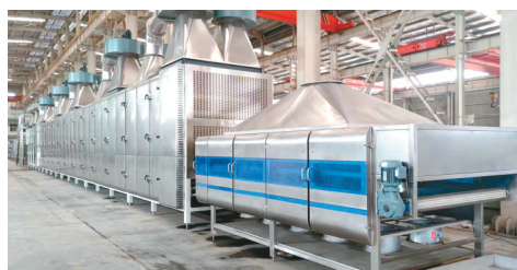
东方面机生产的850型方便面烘干机
